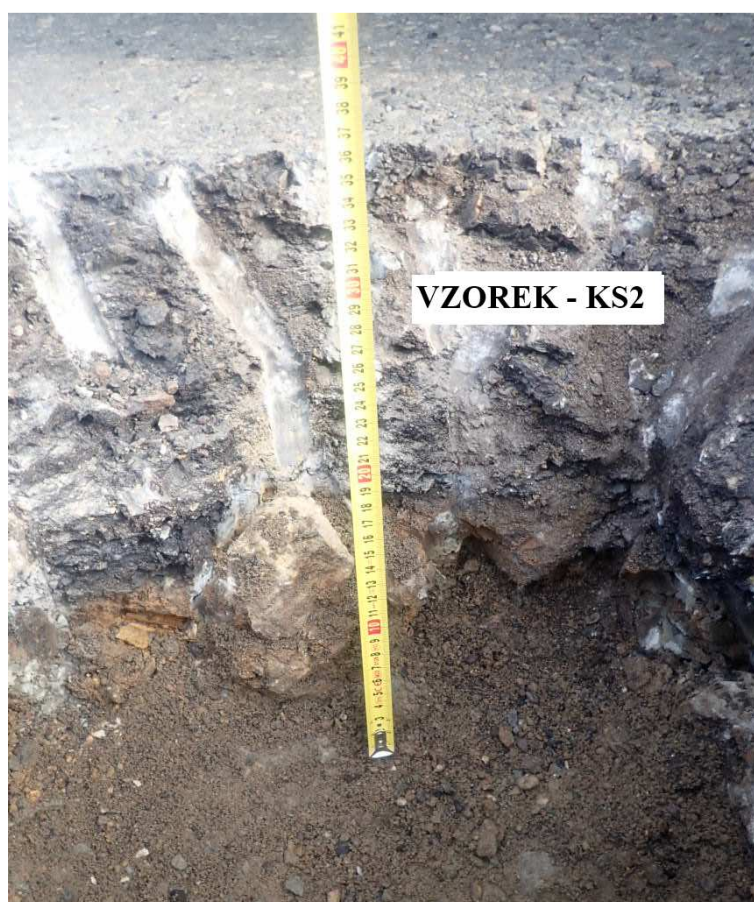
Obr. 2 – Kopaná sonda Vzorek – KS2 (in situ).
